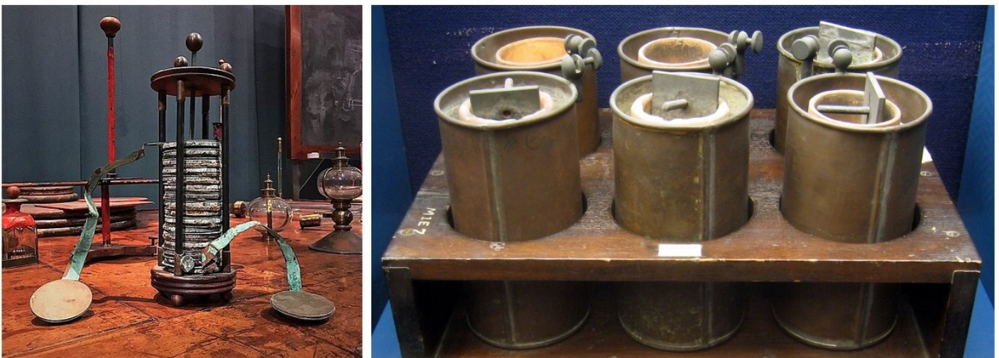
Figure 2. (a, gauche) Pile électrique de Volta exposée au musée pour l'histoire de l'université de Pavie. Markkv, CC BY-SA 4.0 < https://creativecommons.org/licenses/by-sa/4.0/ >, via Wikimedia Commons (b, droite) Pile électrique de Daniell exposée au National
