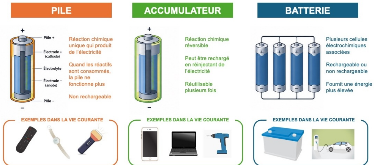
Figure 1. Illustration schématique de la différence entre une pile électrique, un accumulateur et une batterie
