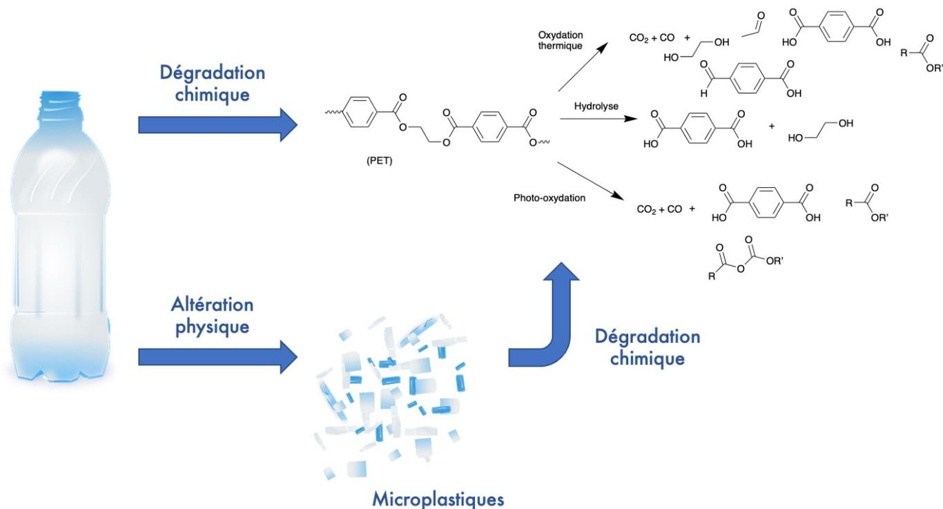
**Figure 4.** Distinction entre la dégradation chimique environnementale et la décomposition physique du PET (le fameux plastique de nos bouteilles d'eau). Le mécanisme chimique est proposé selon les 3 schémas de dégradation les plus fréquents développés par Chamas et al., 2020
