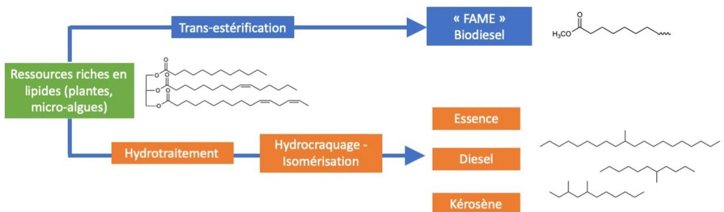
**Figure 5.** Illustration de la production de biodiesel (FAME) ou de diesel renouvelable / essence /carburant pour l'aviation par traitement en présence d'hydrogène.
