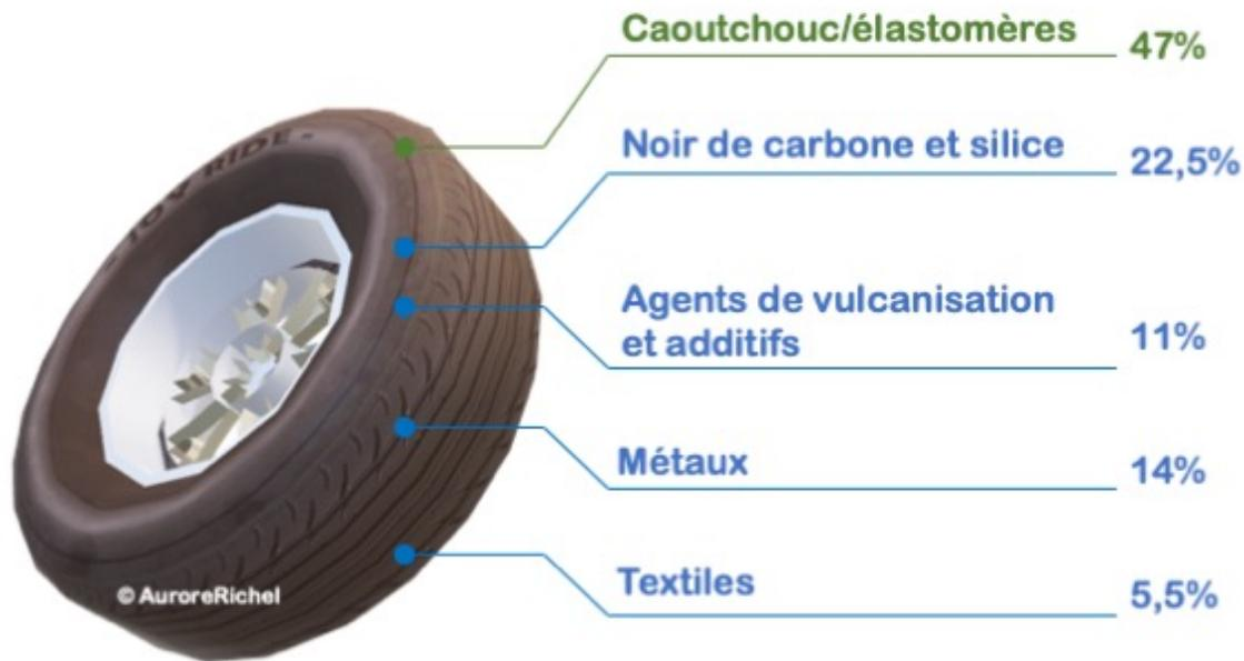
Figure 1. Composition chimique moyenne (exprimée en pourcentages massiques) d'un pneu de voiture
